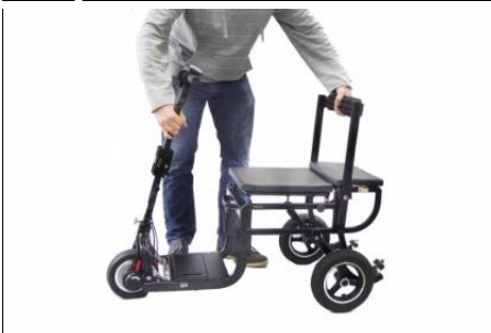
5 Finndu lítinn gular tappa á hliðinni og dragðu til að losa framhjólasamstæðuna.
