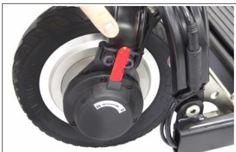
12 Athugaðu hvort segulbremsan sé í LÆSTUR stöðu til að tengja mótórin.
