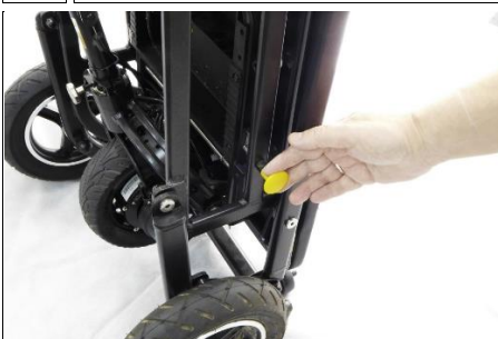
5 Finndu lítinn gular tappa á hliðinni og dragðu til að losa framhjólasamstæðuna.
